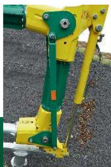
Doppelgelenk mit patentierter Synchronsteuerung
