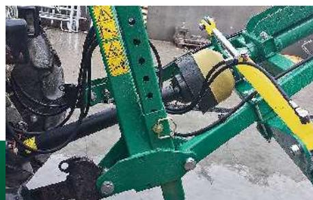
Hydraulische seitliche Schwenkung
