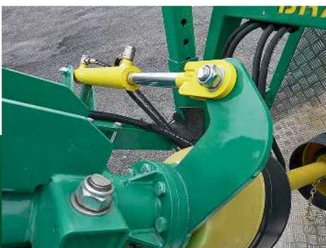
Hydraulische seitliche Schwenkung
