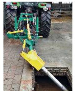
Mit hydraulischer seitlicher Schwenkung
