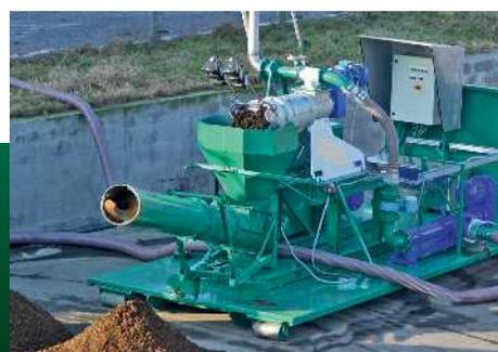
Die Schneckenpresse ist auf einer mobilen Plattform verfügbar.
