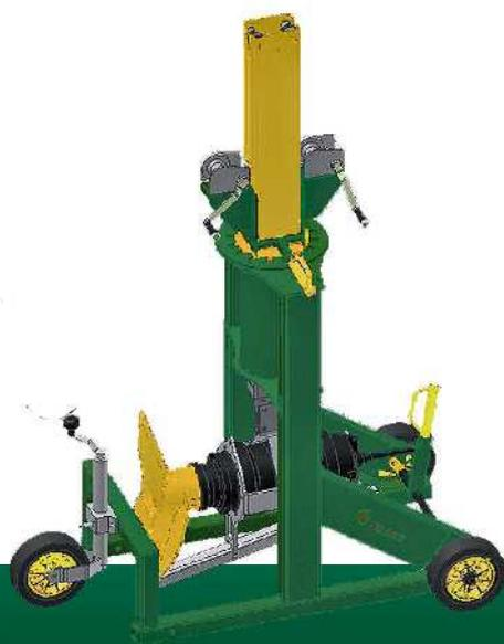
Tauchrührwerk mit Flügel und Planetengetriebe
