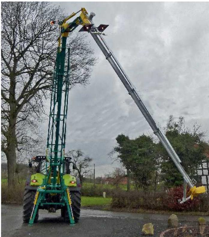
Eine hydraulische seitliche Schwenkung ermöglicht einen noch größeren Aktionsradius
