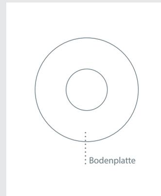
Die Bodenplatte wurde speziell für den Poller Halbkugelkopf mit einem Durchmesser von 20 cm entwickelt.
