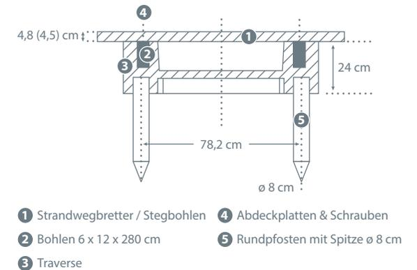
Die Traversen im Abstand von ca. 1,40 m auf den Boden aufsetzen. Zum Ausgleich von leichten Höhendifferenzen können vorher Rundpfosten im Boden verankert werden, auf denen die Traversen mit ihren Öffnungen aufsitzen. Die Längsbohlen anschließend mit den Traversen verschrauben.
