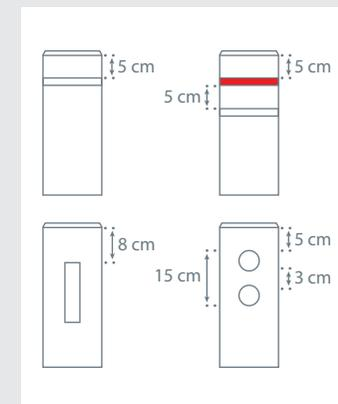
Palisaden und Poller können nachträglich mit Reflektorbändern oder Einzelreflektoren ausgerüstet werden.
